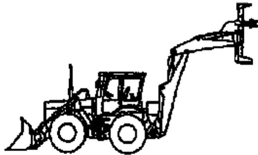
Esempio di terna con attrezzatura per la posa di pali
