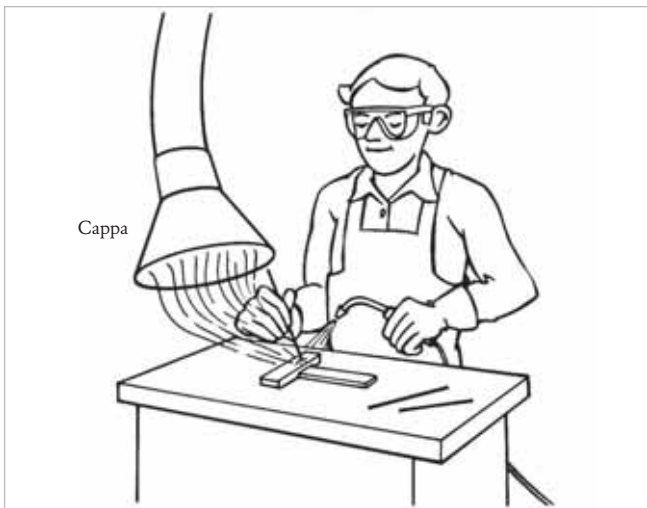
Figura I.10 – Operazione di saldatura Cappa con braccio orientabile
