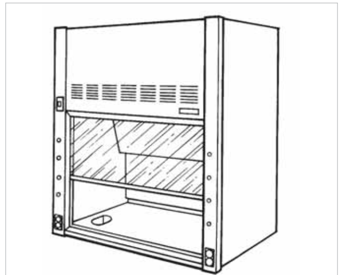
Figura I.9 – Cabina di laboratorio (*)
