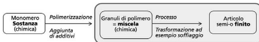
Figura 3.3 Definizioni rilevanti per il PC che è un trasformatore di polimeri. Un articolo semi-finito potrebbe, ad esempio, essere un foglio (film), che viene successivamente utilizzato come imballaggio (articolo finito)
